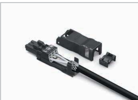
Verdrahteten Steckverbinder in Zugentlastungsgehäuse einlegen und mit Schelle und Oberteil zusammenfügen.
