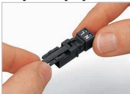
Verriegelungsklinken sind an allen fest zu installierenden Produkten (Snap-In-Varianten, Steckverbinder für Leiterplatten, Verteiler) werkseitig montiert, sodass immer eine Verriegelung mit den zu steckenden Buchsen bzw. Steckern stattfindet. Eine zusätzliche Verriegelungsklinke ist nur bei einer „fliegenden Verbindung“ (Buchse/Stecker) erforderlich.
