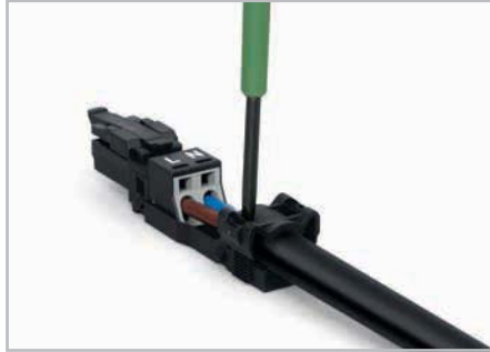
Zugentlastungsschelle mit Schraubendreher, Klingenbreite 2,5 mm, auf beiden Seiten wechselseitig herunterdrücken.
