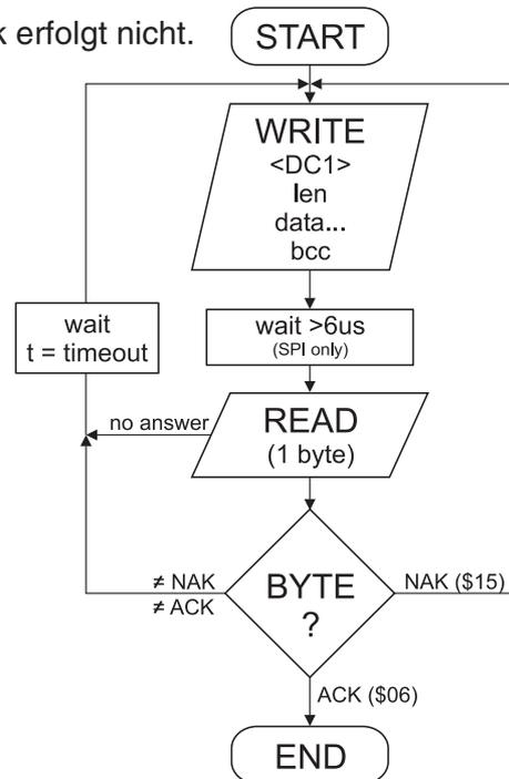
Eingerahmt von <DC1>, der Anzahl der Daten "len" und der Prüfsumme "bcc" werden die jeweiligen Nutzdaten übertragen. Als Antwort sendet das Display <ACK> zurück.
