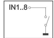
Zusätzlich ist es möglich, bei Änderungen an den Eingängen ein Bit- / Portmakro automatisch aufzurufen (siehe Seite 24). Die automatische Portabfrage lässt sich mit dem Befehl "ESC Y A 1" aktivieren. Bei jeder Änderung des Eingangports werden zuerst die Bitmakros und dann das Portmakro ausgeführt. Ist kein Makro definiert so wird der neue Portzustand in den Sendepuffer gestellt (siehe auch Seite 18: Antworten/Rückmeldungen).
