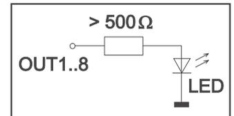
Jeder Ausgang kann per Befehl "ESC Y W" individuell angesteuert werden. Pro Leitung kann ein Strom von max. 10mA geschaltet werden. Es ist somit möglich, mit einem Ausgang direkt eine LED (low current) zu schalten. Für höhere Ströme muss ein externer Transistor verwendet werden.
