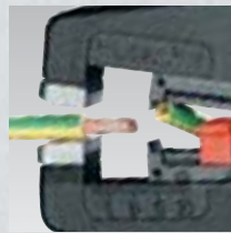
Automatisches Öffnen nach Abschluß des Abisoliervorgangs
