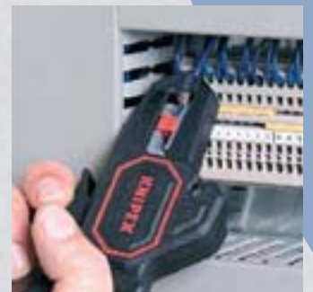
Abisolieren unter beengten Platzverhältnissen
