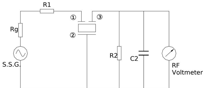
$R1=280\Omega \pm 5\%$ ,  $R2=330\Omega \pm 5\%$ ,  $Rg=50\Omega$  :Input
