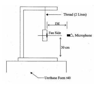
1 METER FROM MICROPHONE TO FAN INTAKE
