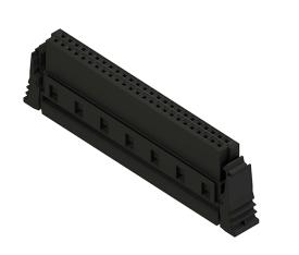
Buchsenleiste im Raster 1,27 mm mit Schneid-Klemm-Anschluss und mit Verriegelung. Empfohlenes Kabel: Flachbandkabel nach UL2678, Raster 0,635 mm, AWG 30.
