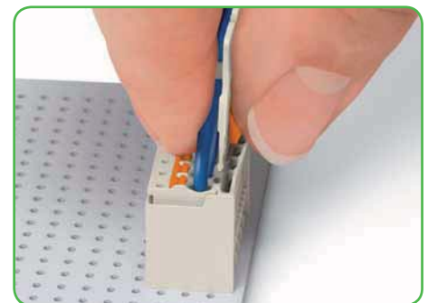
Durch Herunterdrücken des Entriegelungsschiebers an der Griffplatte wird die Verriegelung (Rastlasche) geöffnet.
